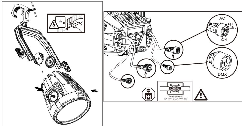
在“DMX控制模式”下，最后一台灯具的DMX 输出端口须连接DMX 回路插。此回路插在“Canon (卡依)”插头的2 针与3 针之间连接了1 个120Ω (OHM) 左右的电阻(如下图所示)。将此回路插插在最后一台灯具的输出口上，可有效地避免DMX512 信号在传输过程中产生的噪音及反射现象。
